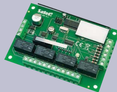
ACX-200 Trådløst modul med 4 trådfaste indgange samt 4 trådfaste udgange, for overføring af signaler zoner og udgange.
