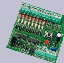
ACX-100 Ind-/Udgangs-modul for ACU-100 med 4 indgange og 8 udgange ACU/100 i stand- alone karfiguration
